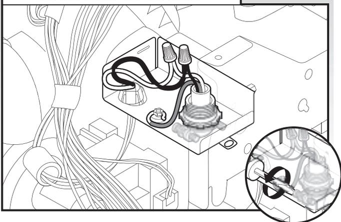
Serrer les vis du connecteur de conduit pour immobiliser le câble.
